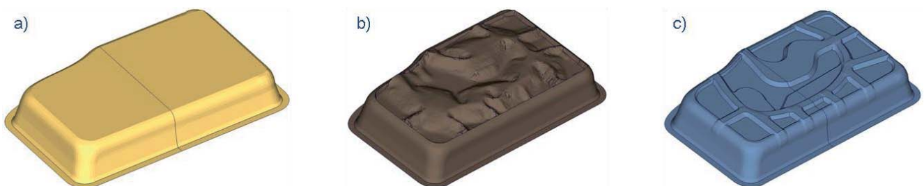
Abb. 8: a) Ausgangsdesign für die Optimierung b) optimiertes Design c) finales fertigbares Design
