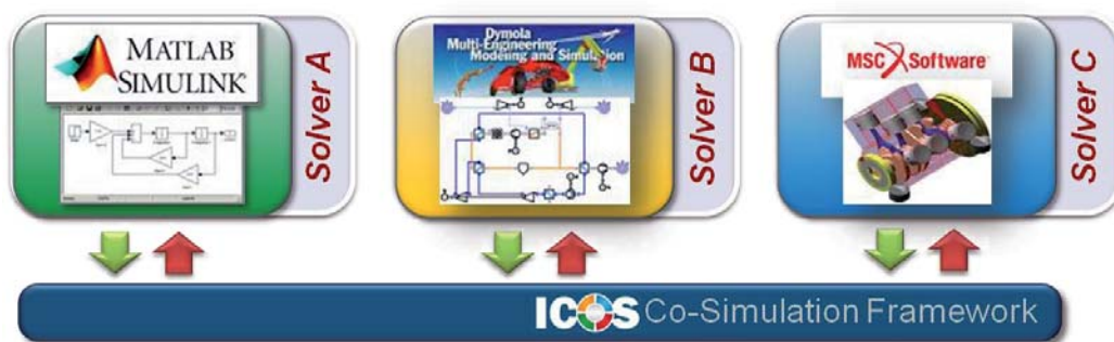
Abb. 2: Kopplung von unterschiedlichen Simulationswerkzeugen mittels einer Co-Simulationsplattform
