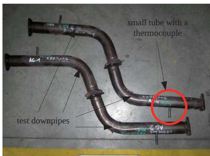
Abb. 6: Test Rohre und das detektierte Versagen durch Beobachtung des Temperaturverlaufes
