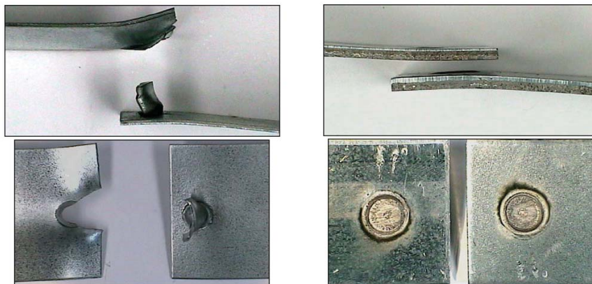
Abb. 3: Ausknöpfbuch (links) und Scherbruch (rechts)
