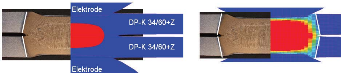
Abb. 12: Fügeprozesssimulation: Schweißlinsengeometrie (links) und Gefügeverteilung (rechts)
