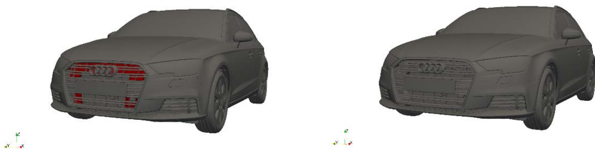
Abb. 5: Links ist das Fahrzeug mit in rot dargestellten Kühlluft Eintrittsflächen dargestellt. Rechts ist das Fahrzeug mit vollständig geöffnetem Kühlluft Eintritt dargestellt.
