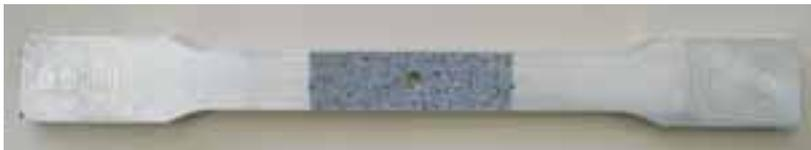
Abb. 22: Versuchsprobe mit stochastischem Muster
